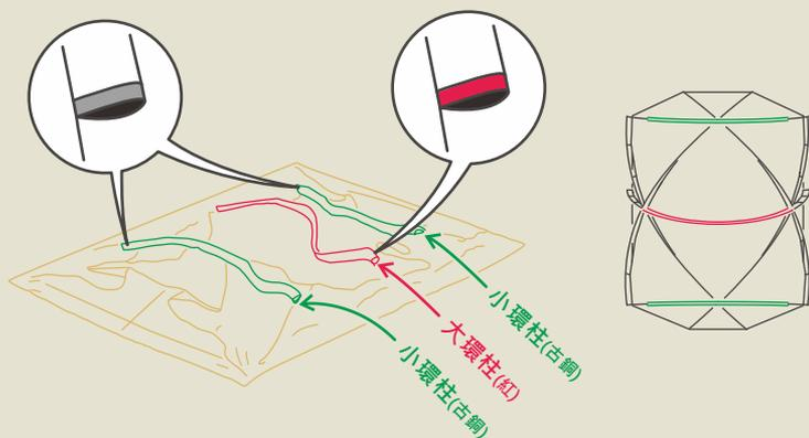
外帳攤平，找出三個平行的管套，並依序安裝營柱。
