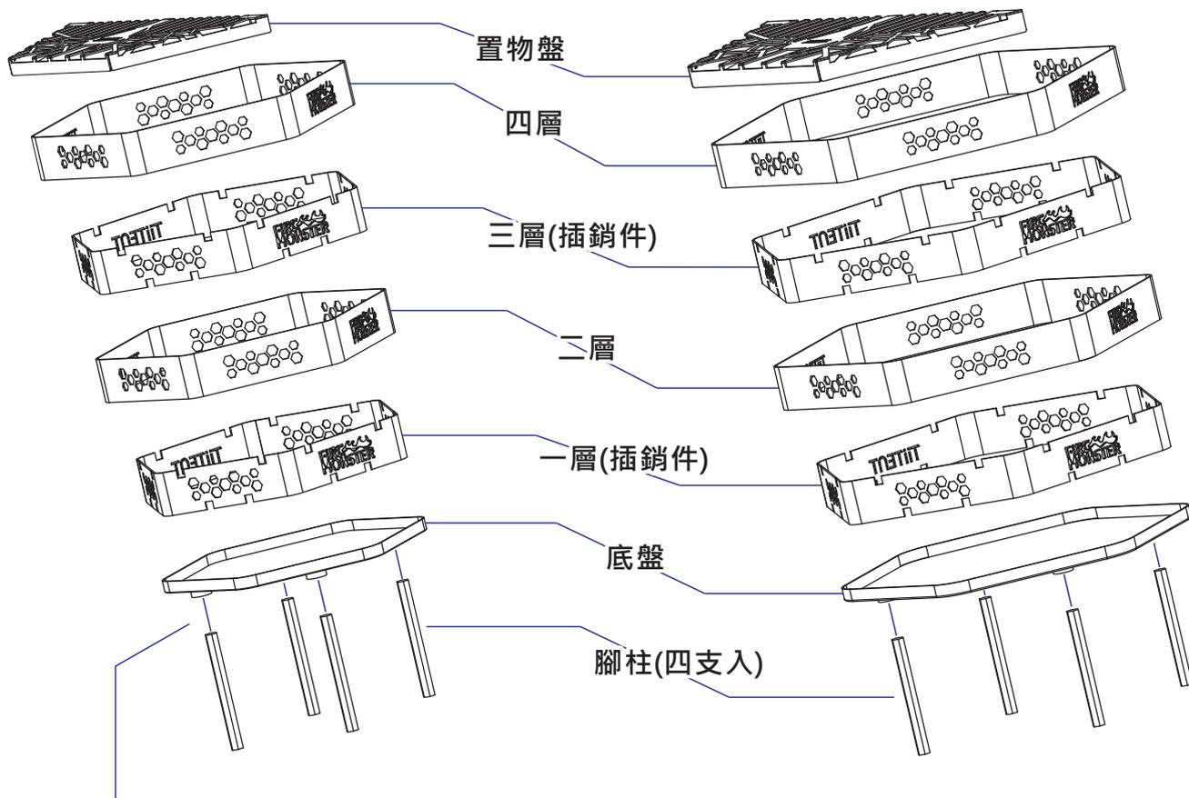
組裝時需將腳柱使用扳手鎖緊
